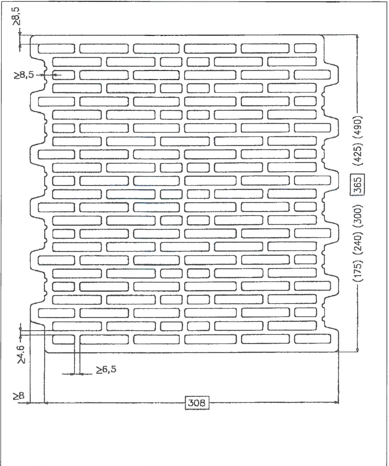
Mauerwerk aus POROTON-T14- und POROTON-T16-Planhochlochziegeln im Dünnbettverfahren
