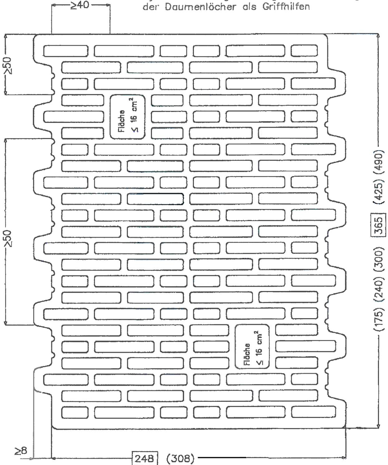
Mauerwerk aus POROTON-T14- und POROTON-T16-Planhochlochziegeln im
